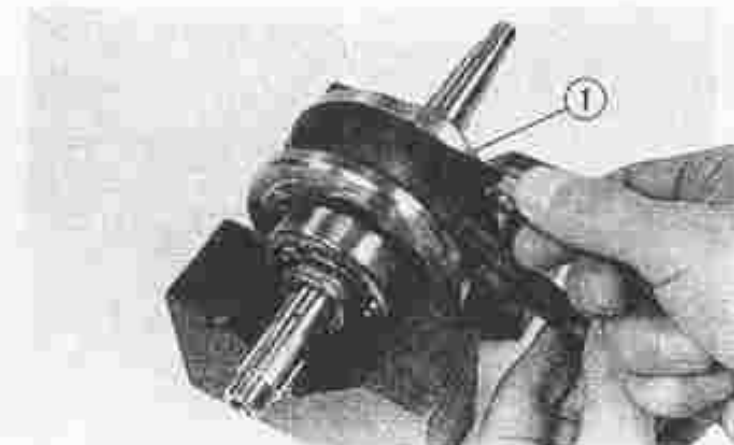
Fig. 53 Meten van speling op grote drijfstangoog.
