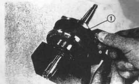
Fig. 53 Meten van speling op grote drijfstangoog. ① Voelmaat
